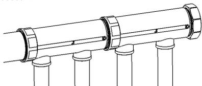
2. Per collegare in serie più collettori coibentati, è sufficiente tagliare il guscio in corrispondenza delle linee marcate già tracciate all'interno del guscio.
