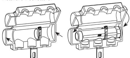
4. Chiudere il guscio in modo da fare aderire la superficie interna al collettore. Fissare il guscio per mezzo degli adesivi già presenti sul guscio.
